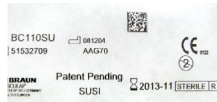
Abb. 9.2: DataMatrix auf SUSI Tyvek Verpackung
